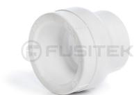
Муфта переходная из полипропилена рандом сополимера (тип 3) серии **FT024** используется для соединения двух труб разных диаметров. Соединение с трубой осуществляется методом термофузионной раструбной сварки. Для получения надежного гомогенного соединения трубы и фитинга используйте профессиональный монтажный инструмент марки Fusitek®. Муфты переходные изготавливаются диаметрами от 20 мм до 110 мм.
