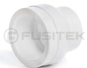
Муфта переходная из полипропилена рандом сополимера (тип 3) серии **FT024** используется для соединения двух труб разных диаметров. Соединение с трубой осуществляется методом термофузационной раструбной сварки. Для получения надежного гомогенного соединения трубы и фитинга используйте профессиональный монтажный инструмент марки Fusitek®. Муфты переходные изготавливаются диаметрами от 20 мм до 110 мм.
